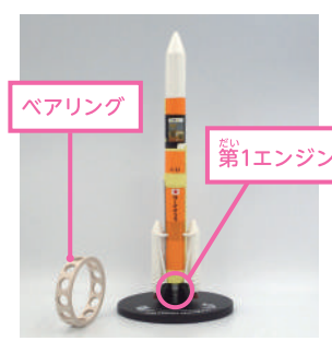
▲ フッ素樹脂が使われているベアリング。第1エンジンで使用されています。
